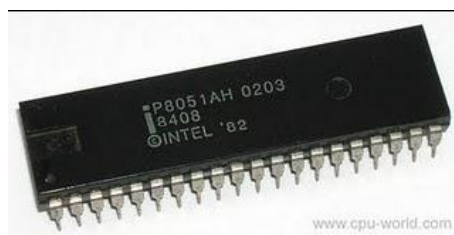
Figura 4: Microcontrolador 8051 da Intel
